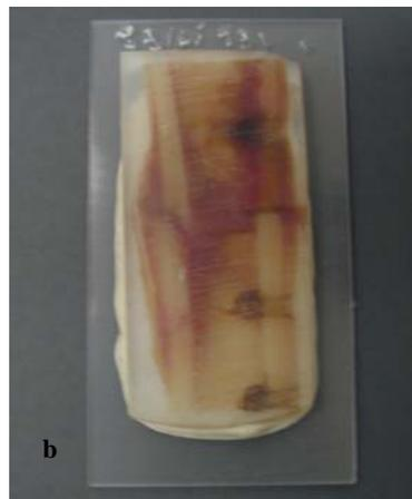
**Abb.2.15.** a) PMMA-Block mit anteriorer Knochenscheibe b) Erstellen eines Sandwich-Präparates 1. Aufkleben des Blockes mit Technovit 4000 auf einen Plexiglasobjektträger 2. planparalleles Abschleifen der freien Seite bis der Knochen komplett an die Oberfläche tritt 3. Gegenkleben eines zweiten Objektträgers mit Technovit 7200, 7min UV- Bestrahlung, Trocknen über 24h
