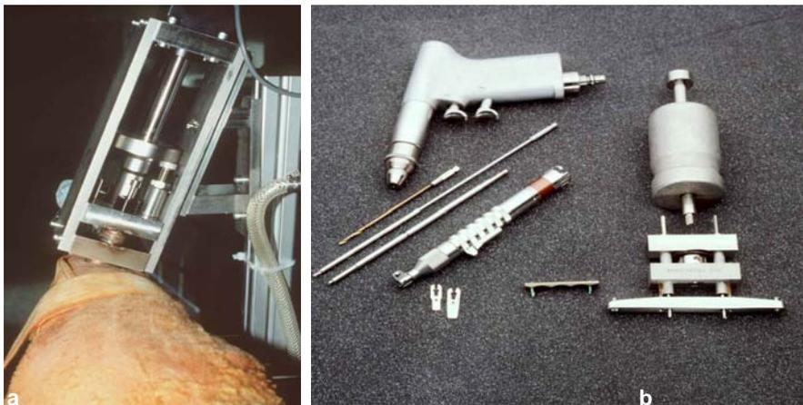
Abb.2.4. a) Versuchsanordnung zum Setzen des Weichteiltraumas b) Instrumente zur Erzeugung der Fraktur
