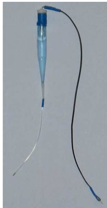
Abb. 3.10 Aufbau der Referenzelektrode
