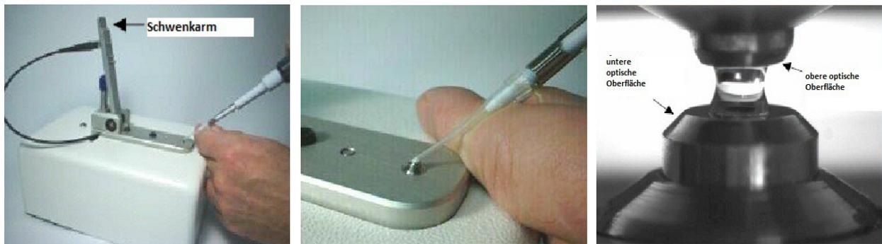
Abb. 8: Darstellung der Aufbringung der Probe auf die optische Oberfläche (links: Übersichtsaufnahme, mitte: vergrößerter Bildausschnitt) und Darstellung der entstehenden Flüssigkeitssäule (rechts) (Thermo Fisher Scientific Nanodrop 1000 Users Manual)
