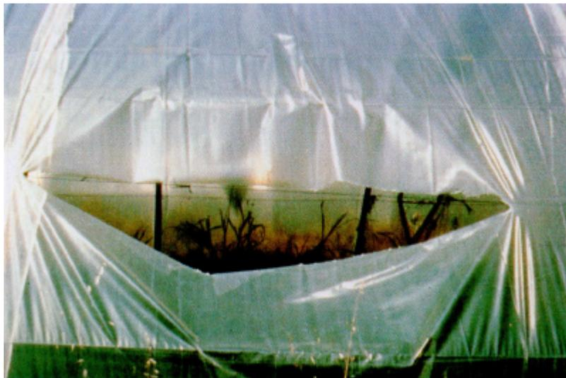
**Abbildung 1.2:** Versprödung des Polymermaterials führte zur Zerstörung einer Gewächshausfolie<sup>[5]</sup>
