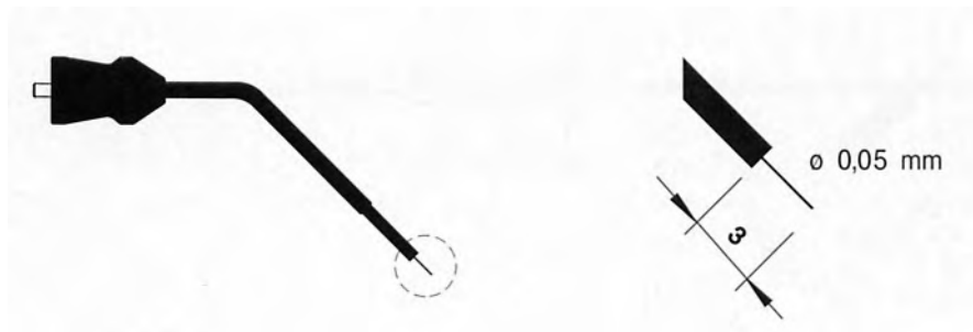
Abb. 4: Monopolare Nadelelektrode mit isoliertem Schaft ( \varnothing 0,2 mm, Länge: 40 mm, gebogen).
