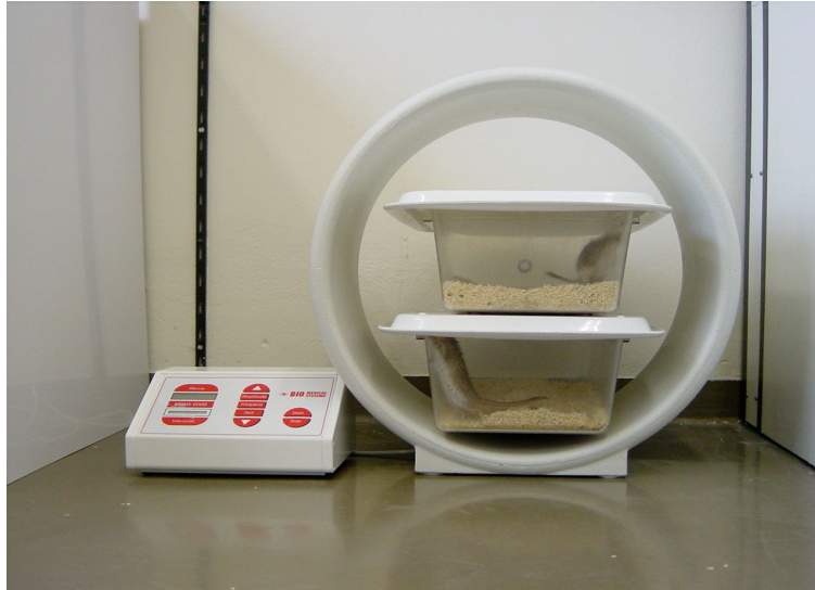
Abb. 3.1.3.1 Dargestellt ist die Helmholtzdoppelspule mit Generator (Biomedical Systems; Model MDMS 2000, Wiesbaden) und zwei Versuchstieren in Standardmakrolonkäfigen Typ III.
