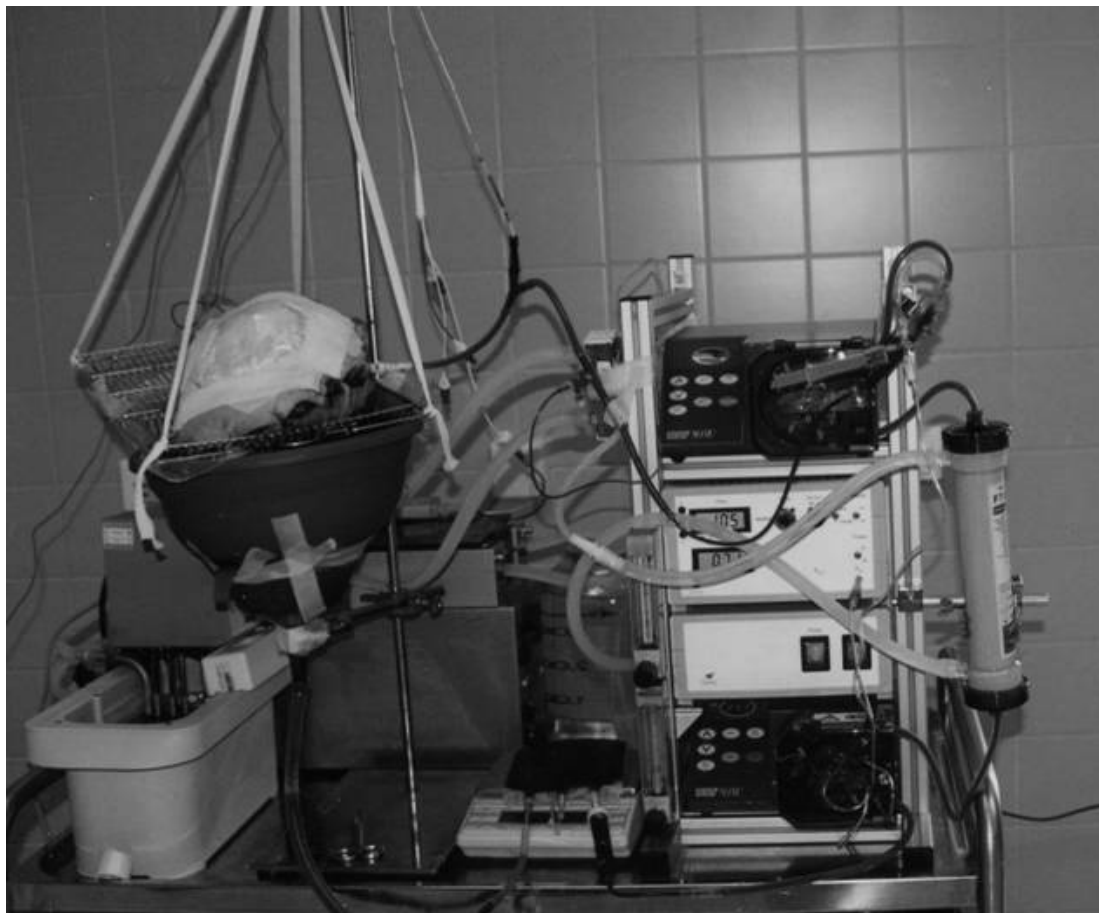
Abbildung 3: Versuchsaufbau. Links im Bild die Extremität, rechts der Perfusionsaufbau mit Rollenpumpen und Steuerungseinheit. Ganz rechts ist das Dialysemodul zu erkennen.
