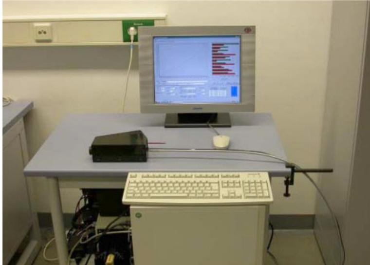
**Abb. 10** Raman-Resonanzspektroskop zur nichtinvasiven Bestimmung des  $\beta$ -Carotin- und Lycopingehalts
