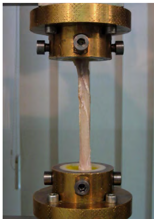
Abbildung 3.18 und 3.19: Eingießen einer Probe für die Torsions- und Kompressionstests unter dem Abzug (links) und in der Materialprüfmaschine (rechts)
