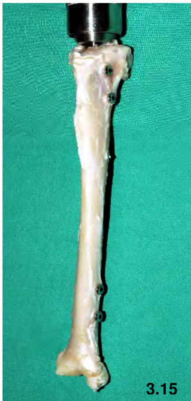
Abbildungen 3.12-3.17: Implantation eines ILN und Setzen eines 5 mm breiten Frakturspalt mit einer Handsäge: 3.12) ILN im Handgriff eingespannt 3.13) ILN in Tibia platziert, Bohrschablone (130 mm) angelegt, erste Bohrung distal gesetzt 3.14) Bohrung proximal 3.15) distal und proximal mit je zwei 2 mm Schrauben verriegelt 3.16) Bestimmung der Fraktur in der Diaphysenmitte, Sägeblatt 3.17) 5 mm klaffender Frakturspalt
