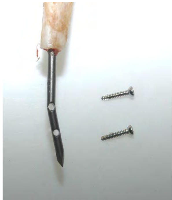
Abbildung 4.23 und 4.24: Biegung des ILN mittig am Frakturspalt (links) und im oberen Schraubenloch des distalen Nagelabschnitts (rechts) im Biegeversuch
