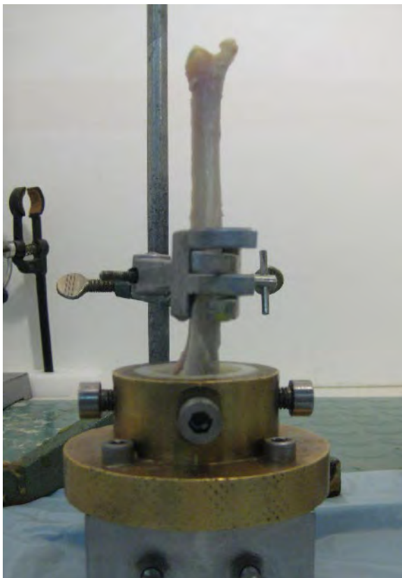
Abbildung 3.18 und 3.19: Eingießen einer Probe für die Torsions- und Kompressionstests unter dem Abzug (links) und in der Materialprüfmaschine (rechts)
