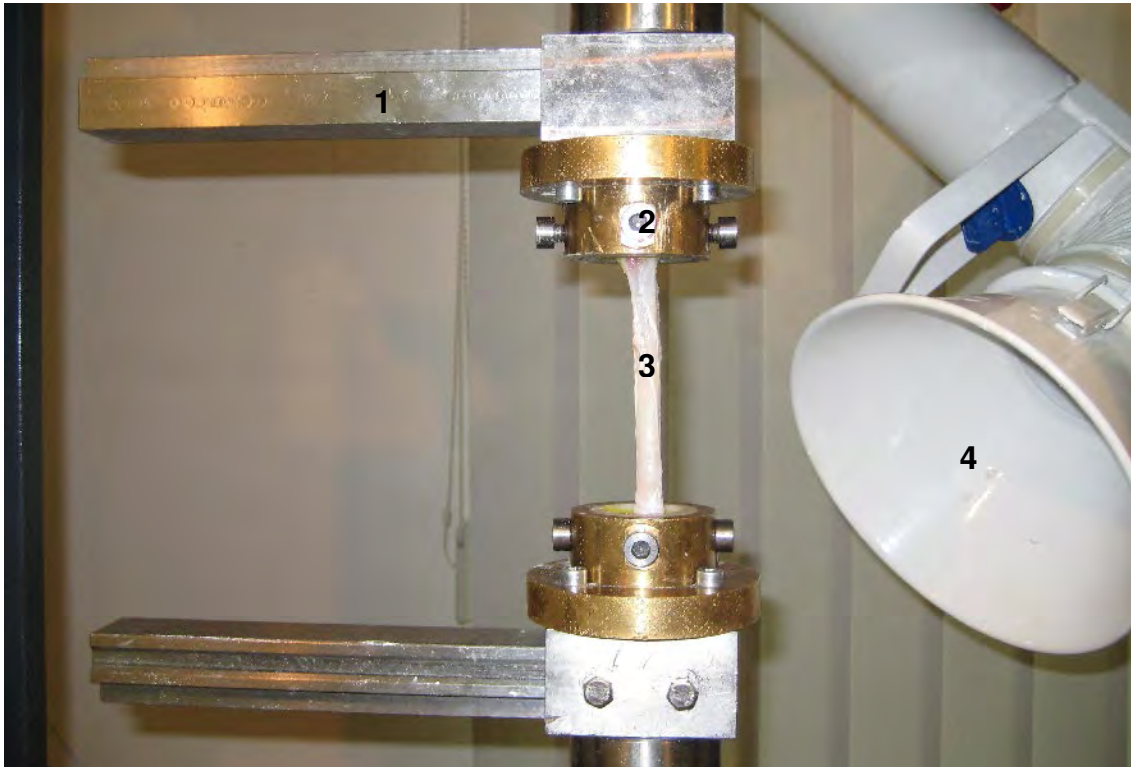
Abbildung 3.23: Lagerung eines Versuchsobjekts für Torsions- oder Kompressionsversuche: 1) Führungsschiene der Materialprüfmaschine 2) Einbettformen 3) Knochen 4) Abzug
