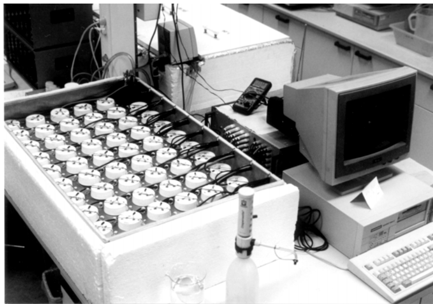
Abbildung 22: Anlage zur CO 2 -Messung
