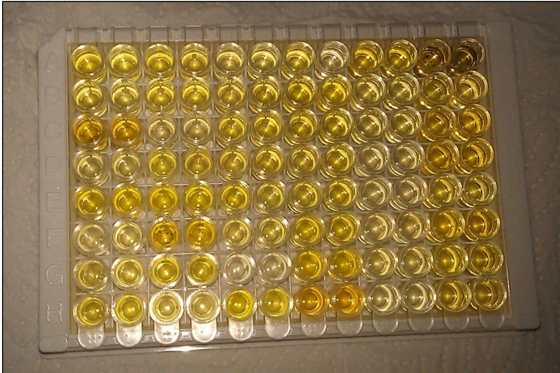
Abb. 9 Mit HCL gestoppte Farbreaktion in 96-Lochplatten, ELISA EK-022-06 Endorphin, beta (Mouse, Bovine, Ovine, Camel), Phoenix Europe GmbH.
