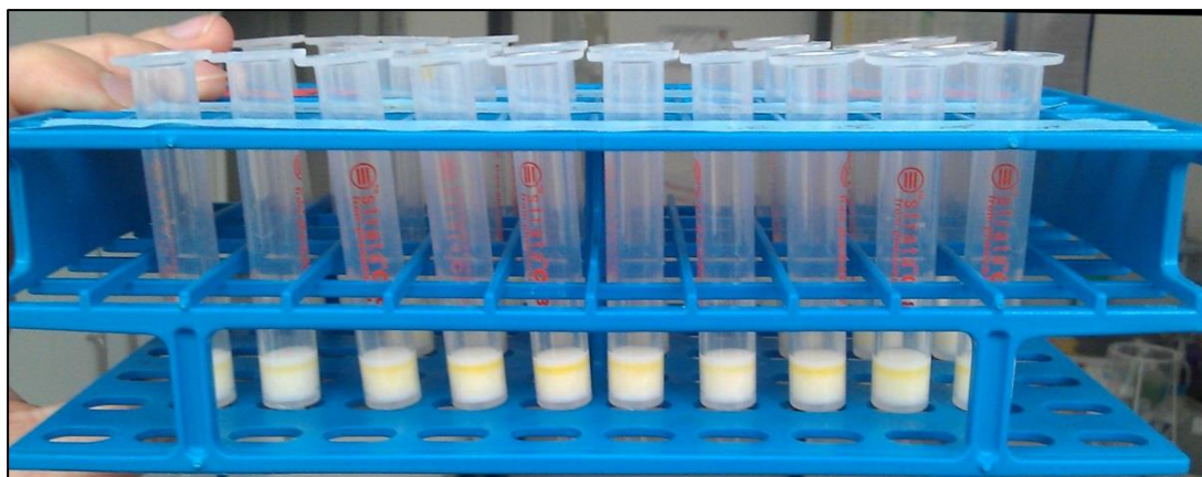
Abb. 7 Extraktionsverfahren mit Strata®-C18-Sep-Säulen (Phenomenex Inc.).
