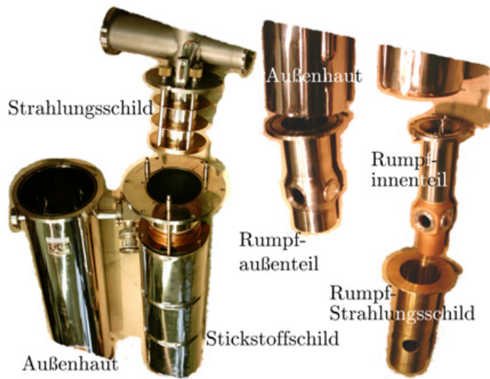
Abbildung 3.5: Photographische Darstellung der einzelnen Elemente des verwendeten Helium-Badkryostaten in zerlegtem Zustand. An den Rumpfteilen erkennt man einige der mit Indium gedichteten Quarzglasfenster. Der Rumpfbereich wird durch einen kupfernen Strahlungsschild, der eine gute Wärmeanpassung an das Stickstoffreservoir besitzt, weitgehend vor Wärmeeinträgen geschützt. Im oberen Bereich befinden sich ebenfalls Strahlungsschilde aus Kupfer, die an den Stickstofftank angeschlossen, damit die Innenraumwände möglichst keiner Fläche mit Raumtemperatur zugeneigt sind.
