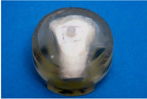
Abb. 16: Fertiger Adhäsivzylinder auf eingebettetem Zahn
