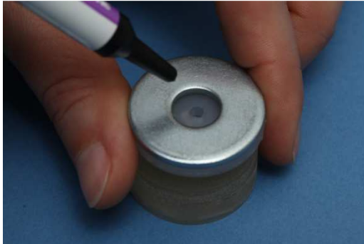
Abb. 24: Aufbringen eines Adhäsivzylinders auf ein eingebettetes Bracket
