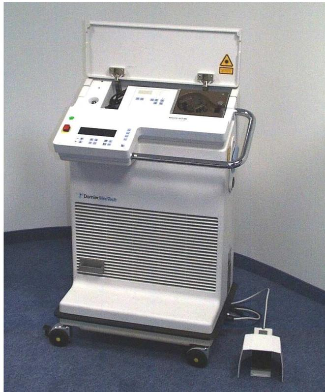
**Abb. 7:** Nd:YAG-Lasersystem mit integrierter Spülpumpe für die laserinduzierte Thermotherapie
