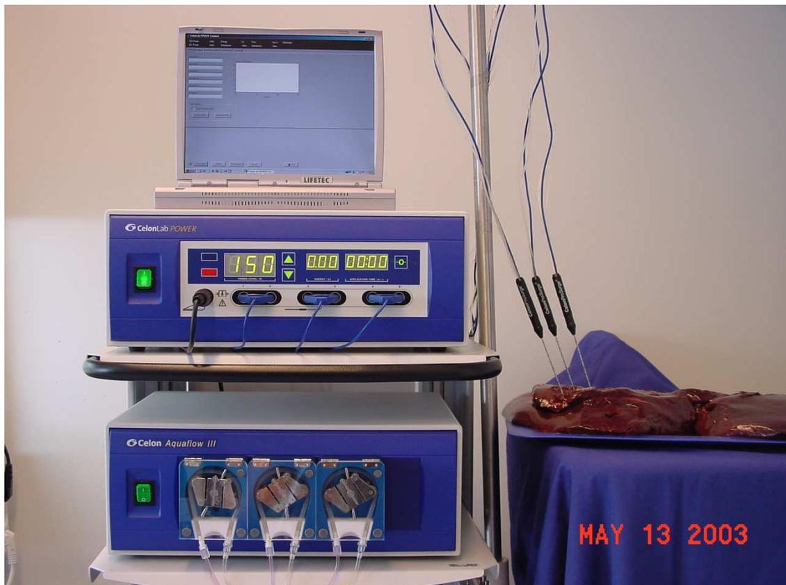
**Abb. 1:** Arbeitsplatz mit Laptop, Leistungssteuerungsgerät, Peristaltikpumpe und drei im Gewebe positionierten bipolaren Radiofrequenzapplikatoren
