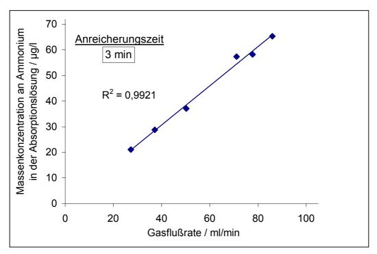
**Abb. 5-24.** Abhängigkeit der Massenkonzentration an Ammonium in der Absorptionslösung von der Gasflußrate des Ammoniak-haltigen Gasgemisches.
