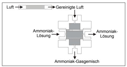
Abb. 5-22. Aufbau für die Herstellung des Ammoniak-haltigen Gasgemisches
