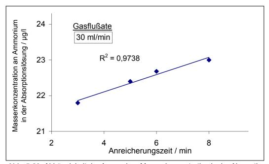
**Abb. 5-23.** Abhängigkeit der Ammonium-Massenkonzentration in der Absorptionslösung von der Anreicherungszeit des Ammoniak-haltigen Gasgemisches.
