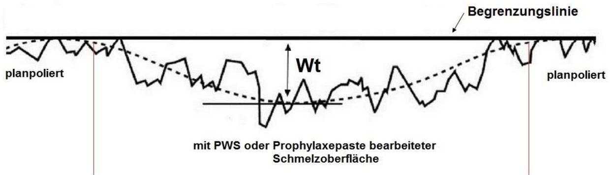
Abb. 10 Schematische Darstellung für die Wellentiefe ( $W_t$ ) zur Bestimmung des maximalen Schmelzverlustes
