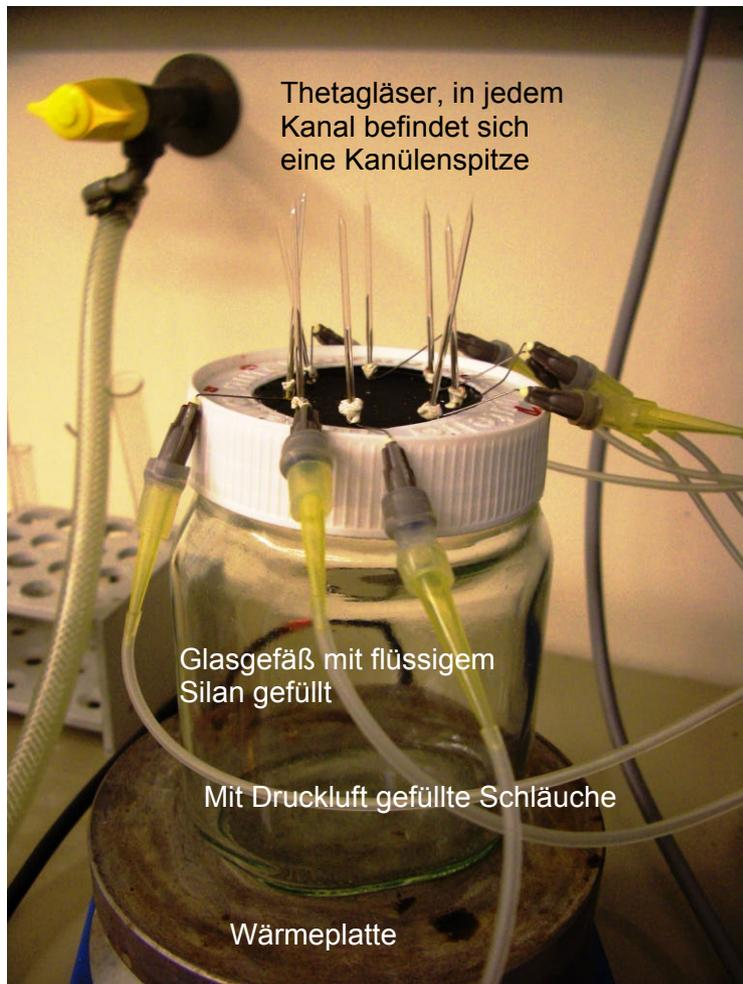
Abbildung 2: Auf dieser Abbildung ist die selbstgebaute Apparatur zur Silanisierung der Elektroden zu sehen. Das mit Silan gefüllte Glasbehältnis steht auf einer Wärmeplatte. Die Druckluft gelangte über Schläuche und Kanülen in den nicht zu silanisierenden Kanal der Glaselektrode. Von innen durch das Gummi des Deckels gestochene Kanülen lagen mit der Spitze im zweiten Kanal, durch die das gasförmige Silan in eben diesen eindringen konnte. Die Apparatur stand unter einem Abzug.
