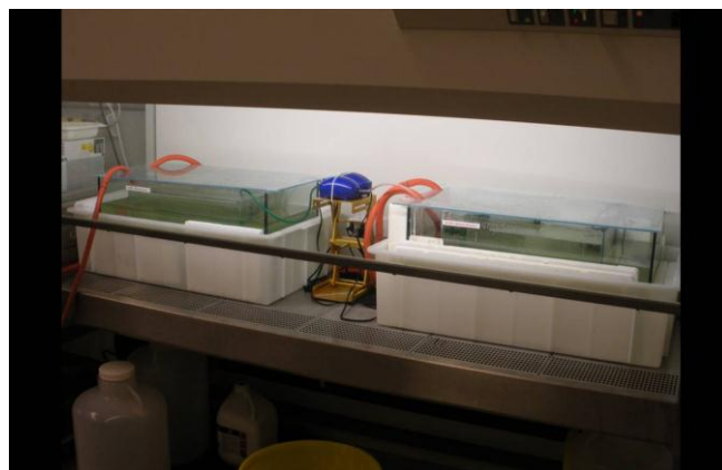
Abbildung 3: Versuchsanlage Kontaminationsbecken (rechts) und Hälterungsbecken (links), am BfR, Marienfelde
