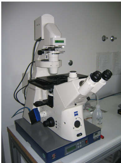
Abb. 13: Inverses Mikroskop des Axioverts mit angeschlossener Kamera
