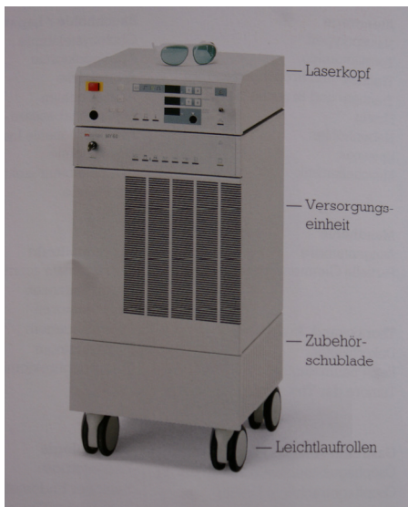
Abb. 3: Nd:YAG-Laser (Quelle: Martin Medizintechnik)
