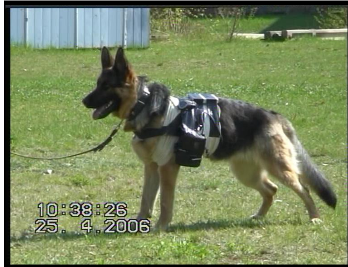
Abb. 10: Hündin mit Polar ® - und SMARD-Watch ® -Sensor (unter dem Brustverband), WAS-Beschleunigungssensor (mittig auf dem Rücken) sowie den Datenrecordern des Polar ® und der SMARD-Watch ® (in der Tasche des Brustgeschirrs)
