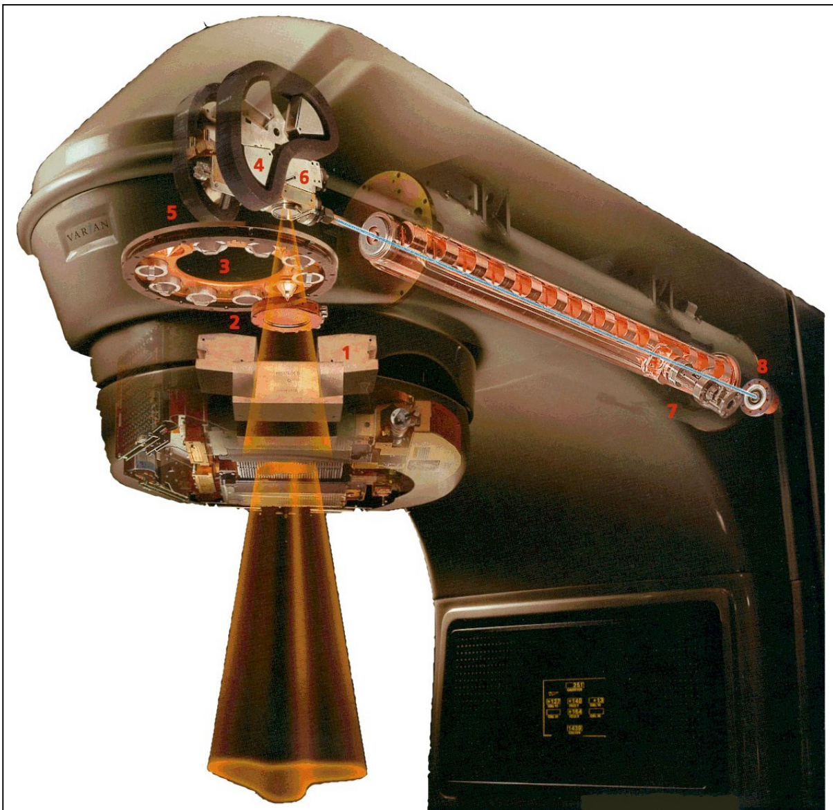
Abbildung 2.1: Darstellung eines Linearbeschleunigers der Firma Varian Medical Systems mit seinen wesentlichen Komponenten: Triode zur Erzeugung des Elektronenstrahls (8), Beschleunigungsrohr (7), 270° Umlenksystem (4), Bremstarget (6), Karussell mit Ausgleichsfilter (5) und Streufolien (3) für verschiedene Photonen- und Elektronenenergien, Dosismonitorsystem (2), Blendenpaare und Multilamellenkollimator (MLC) zur Formung des Bestrahlungsfeldrandes (1). Quelle: [84].
