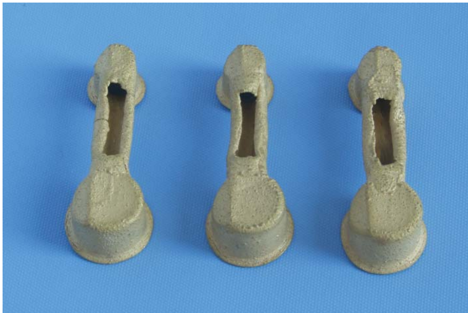
Abb. 26: Warzige Galvanogerüste mit Rissbildung
