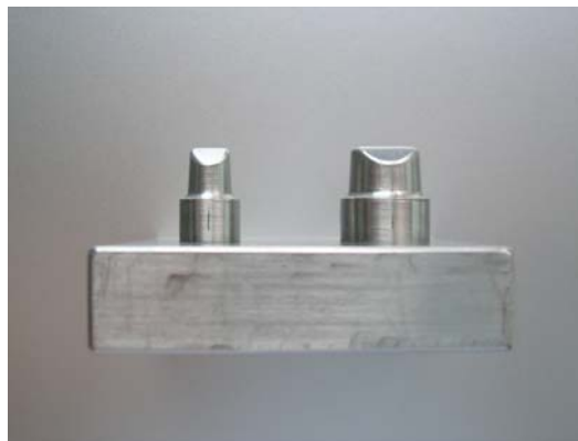
Abb. 7: Prüfmodell aus Edelstahl (V2A)
