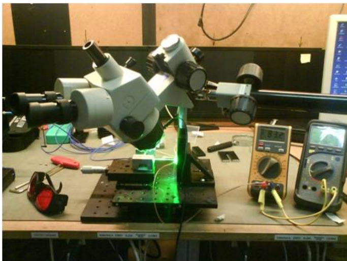
Abb. 31: Arbeitsplatz mit Mikroskop zur Feinjustierung des Abstandes LWL zur Photodiode und grüner Laserstrahl
