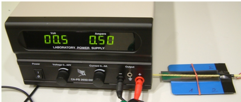
Abb. 42: Gleichstromnetzteil 500 mA eingestellt und Zylinderspule auf Thermofolie
