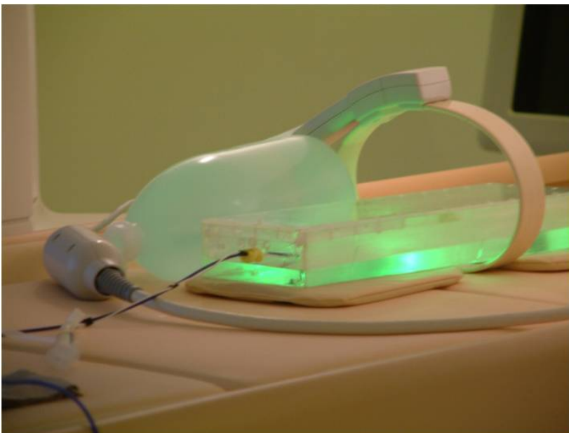
Abb. 37: Katheter im Elektrolytbad mit LWL und Multi Purpose-Spule während Bestrahlung mit 525er (grünem) Laser
