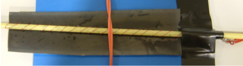
Abb. 41: Zylinderspule auf Thermofolie fixiert auf Kunststoffspachtel (blau)
