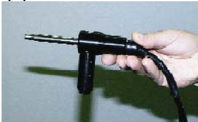
Abbildung 3: Orthogonal polarization spectral imaging Messkopf nach Groner et al.[110]
