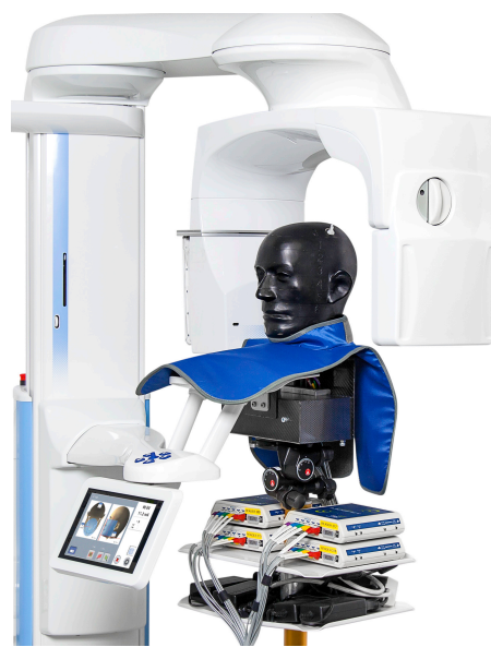
Abb. 12: Rando®-RAN Phantom Kopf mit angelegtem Schilddrüsenschutz, Ansicht von links lateral
