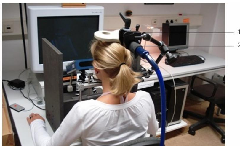
**Abbildung 13:** Foto des Versuchsaufbaus der TMS-Stimulation des Vertex. Die Probandin fixiert den Monitor, während der Kopf mittels Beißbrett immobilisiert wird. Befestigung der Doppelspule (2) am MagicArm© (1). Für die Stimulation des FEF wurde die Spule um 90° zur Sagittalebene gedreht, der Griff befand sich rechts.
