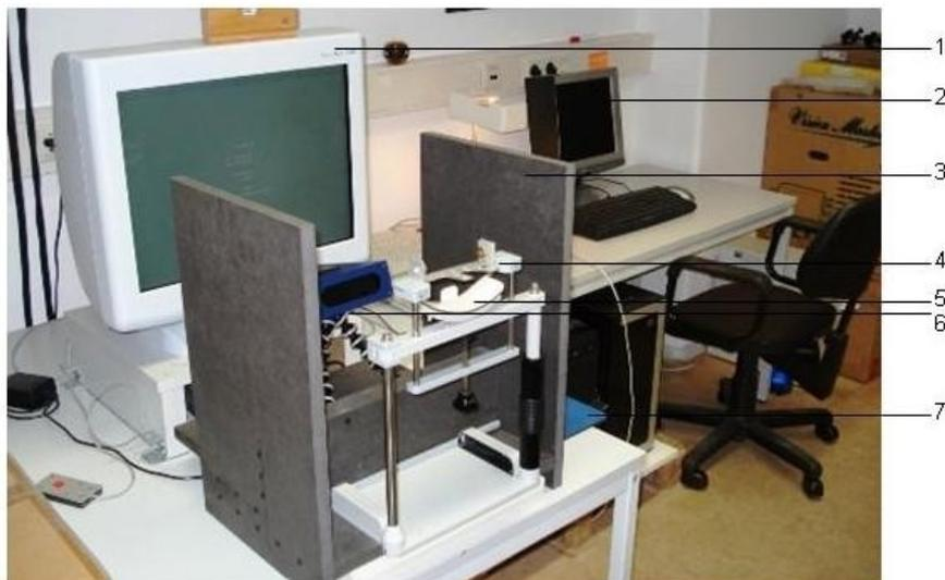
**Abbildung 6:** Versuchsaufbau. Stimulusmonitor (1), Videookulographierechner (2), Sichtschutz (3), Beißbrett (4), Kinnstütze (5), Augenbewegungskamera (6), Computermaus für manuelle Positionsurteile (7).
