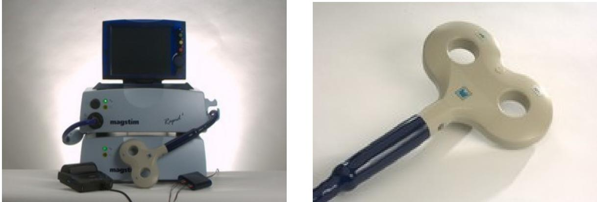
**Abbildung 12:** Links: Magstim Rapid<sup>2</sup> Stimulationsgerät, rechts: Doppelspule der Magstim Company.
