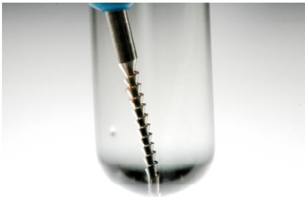
Abb. 12: Hedström-Feile in 1 %iger SDS-Lösung nach 5 min Lagerung in Kochsalzlösung 0,9 %
