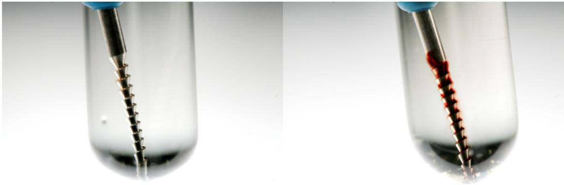
Abb. 20: Restkontamination an Hedström-Feilen der ISO-Größe 120 in 1 %iger SDS-Lösung nach 5 min Lagerung in physiologischer Kochsalzlösung 0,9 % (links) und in Isopropanol 70 % (rechts)
