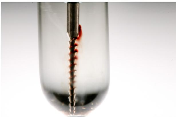
Abb. 16: Hedström-Feile in 1 %iger SDS-Lösung nach 5 min Lagerung in Chlorhexidindiglukonat B
