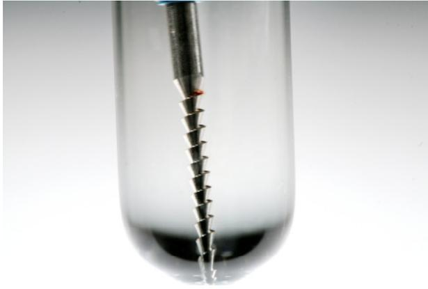
Abb. 11: Hedström-Feile in 1 %iger SDS-Lösung nach 5 min Lagerung in Chlorhexidindiglukonat 0,2 %
