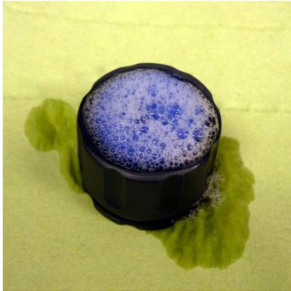
Abb. 19: Schaumbildung in einem Interim-Stand gefüllt mit 20 ml Endo CHX 2 % nach mehrmaligem Durchstechen der Schaumstoffscheibe mit einer Hedström-Feile
