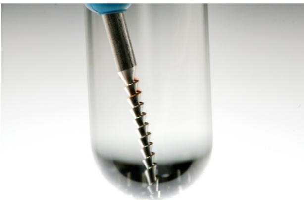
Abb. 14: Hedström-Feile in 1 %iger SDS-Lösung nach 5 min Lagerung in Polyhexanid 0,04 %
