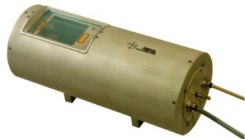
RIEGL Q140i Outdoor (60/80°) Range: 450m Stat. error: 2,5 cm
