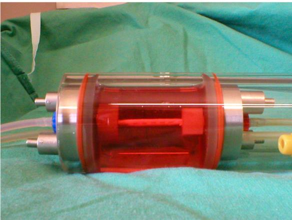
**Abbildung 2.4:** Eingespannte ePTFE-Prothese wurde mit RAEC besiedelt und die Außenkammer mit Zellkulturmedium gefüllt
