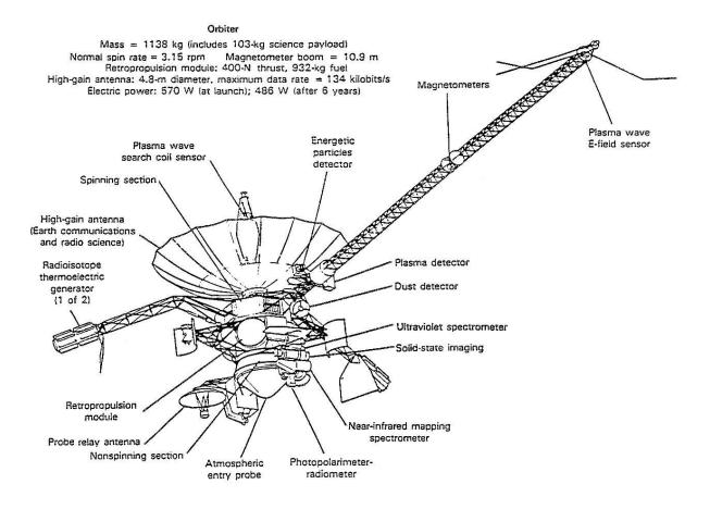
Abbildung 4.2.: Wissenschaftliche Instrumentierung der Galileo-Sonde. Die Darstellung zeigt die Konfiguration mit der noch an der Muttersonde befestigten Atmosphärenprobe.
