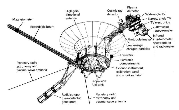
Abbildung 4.1.: Wissenschaftliche Instrumentierung der Voyager-Sonden.
