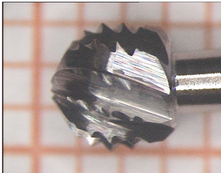
Abbildung 10: Sauberes Arbeitsteil eines Knochenfräasers (Nr. 3) aus Hartmetall (Versuch B) unter dem Stereolichtmikroskop mit 20-facher Vergrößerung aufgelegt auf eine Zentimeterfolie, 1 Kästchen entspricht 1 mm
