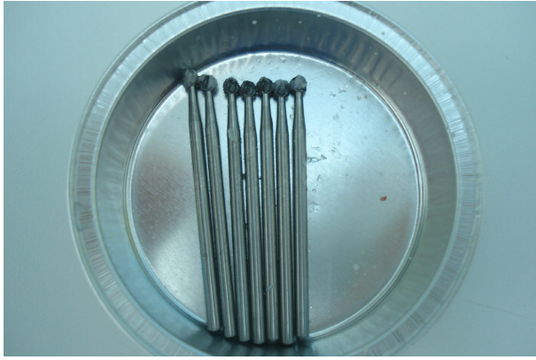
Abbildung 7: Am Schweinekieferknochen kontaminierte Knochenfräser (Hartmetall) vor der Aufbereitung
