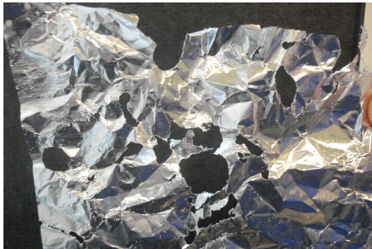
Abbildung 9: Perforierte Aluminiumfolie (10 x 10 cm) nach 15 min im Ultraschallbad mit VE-Wasser
