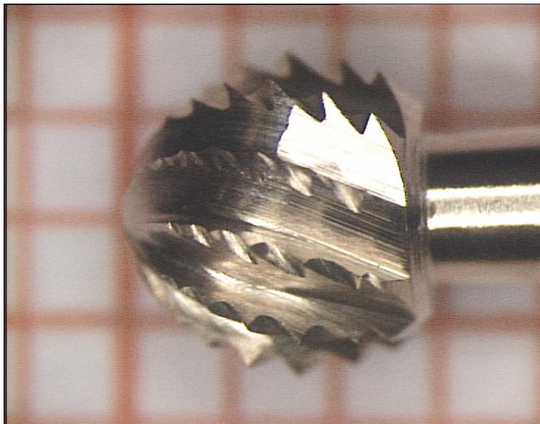
Abbildung 14: Sauberes Arbeitsteil eines Knochenfräasers (Nr. 4) mit Zirkon-Nitrid-Hartbeschichtung (Versuch B) unter dem Stereolichtmikroskop mit 20-facher Vergrößerung aufgelegt auf eine Zentimeterfolie, 1 Kästchen entspricht 1 mm
