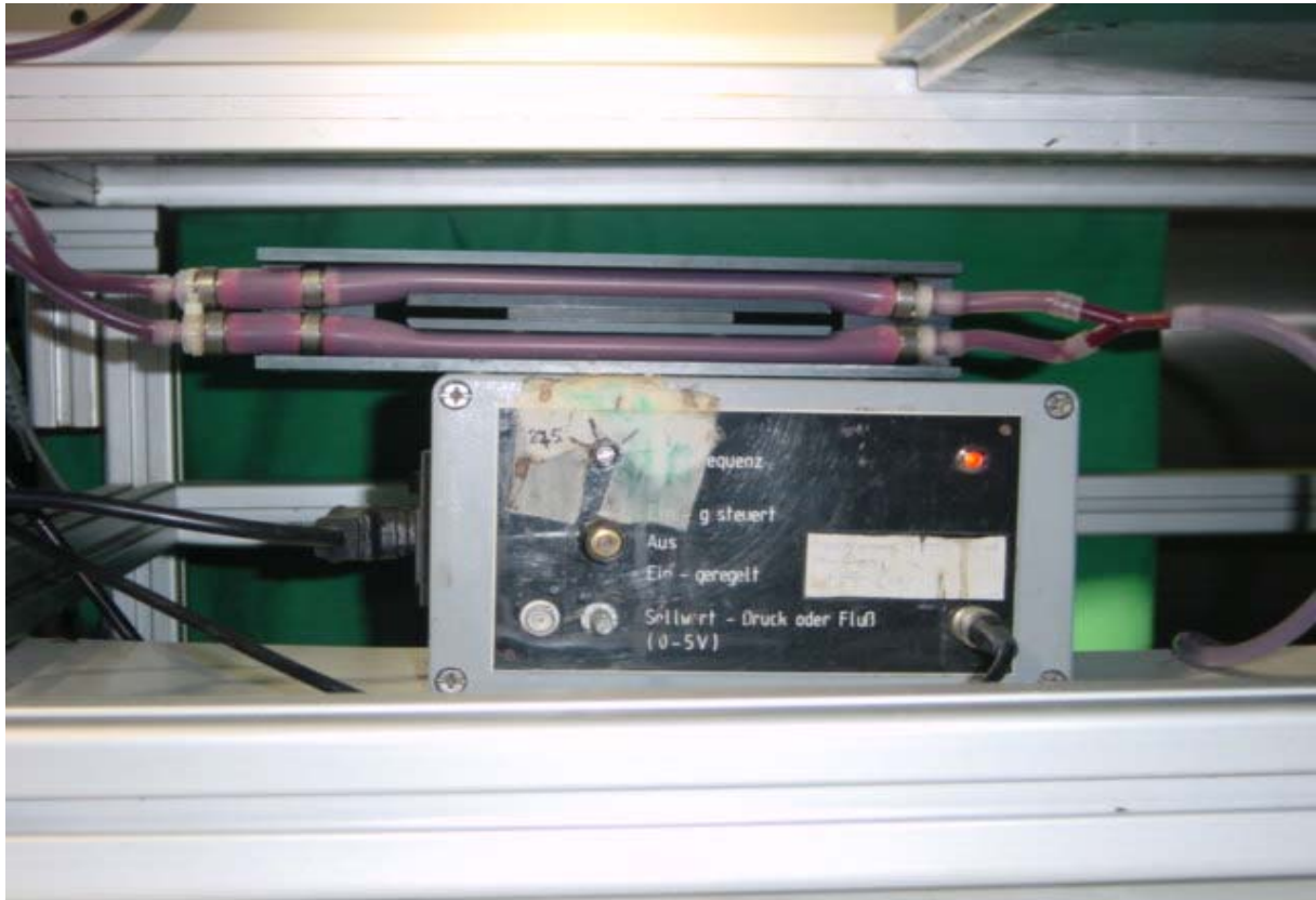
Abb. 1: Photo der doppelten Schlauchventilpumpe nach Affelt, K.
