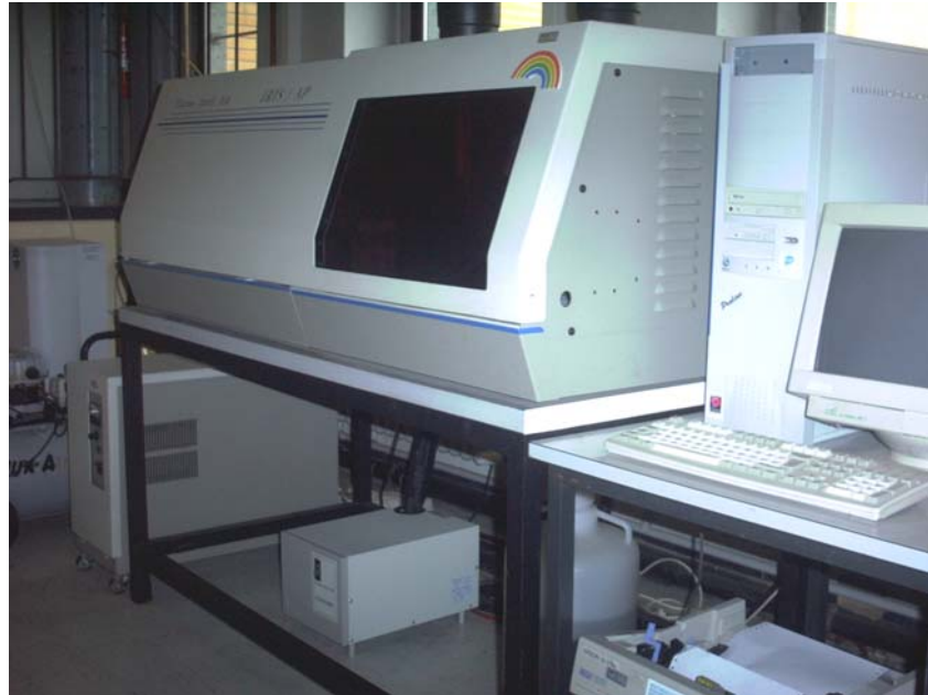
Abb. 4-18: IRIS/AP-Spektrometer der Firma Thermo Jarrell Ash
