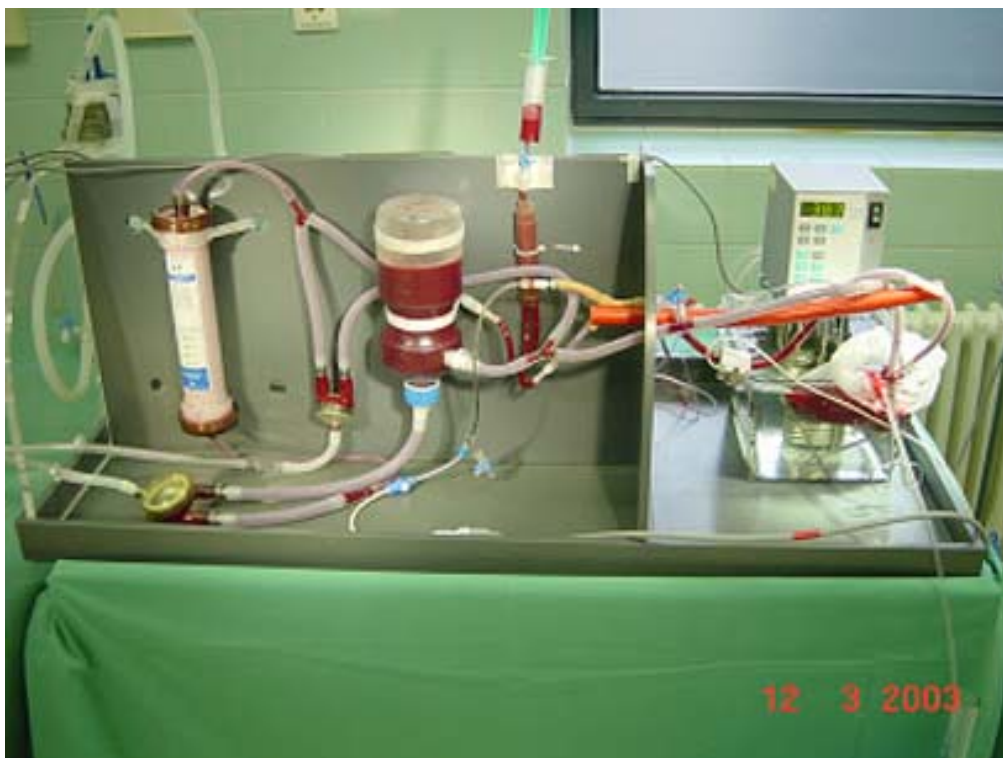
Abb. 2 Versuchsaufbau zur Perfusion der Niere (pneumatische Blutpumpen)
