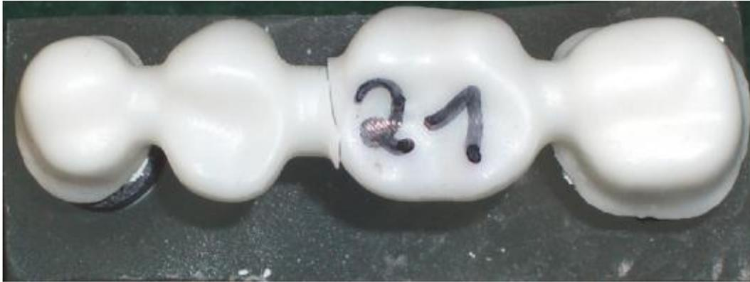
Abbildung 14: Typischer Frakturlinienverlauf für die 5. Serie (R o.Th.) ohne Thermocycling nach dem Bruchversuch
