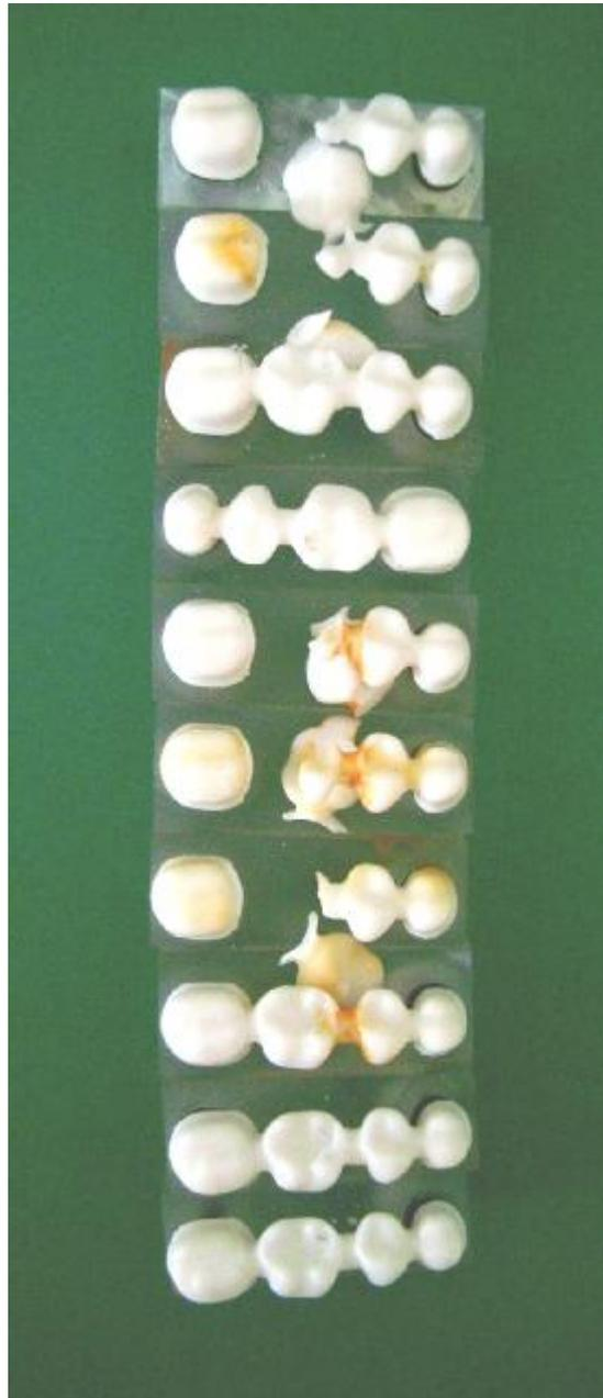
Abbildung 17: Die 2. Serie (C m.Th.) aller Brückengerüste mit künstlicher Alterung durch Thermocycling nach erfolgtem Bruchversuch
