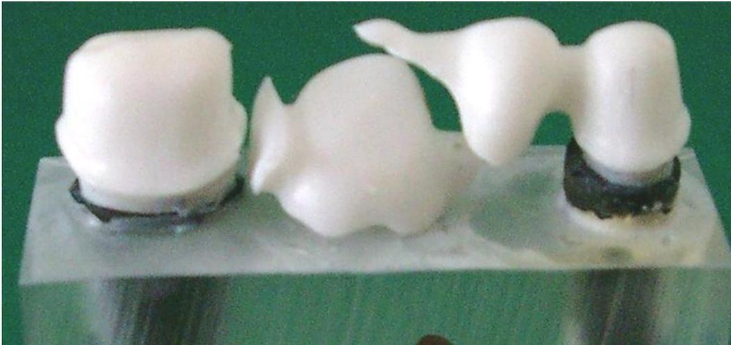
Abbildung 15: Typische Aussprengung des Zwischengliedes 16 bei der Hälfte aller Brückengerüste der 2. Serie (C m.Th.) nach Thermocycling
