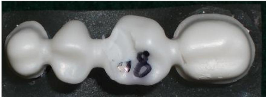
Abbildung 12: Doppelfraktur mit zusätzlicher okklusaler Aussprengung an der Probe B o.Th. 18 aus der 3.Serie (B o.Th.)
