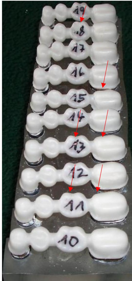
Abbildung 13: Die 3. Serie (B o.Th.) aller Brückengerüste ohne Thermocycling nach dem Bruchversuch
