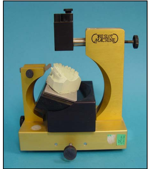
Abb. 6: Slotmaschine. Ähnliches Positionierungsprinzip wie bei dem TARG. Es können jedoch auch Werte erster Ordnung (Rotation) bei der Bracketpositionierung eingestellt werden.
