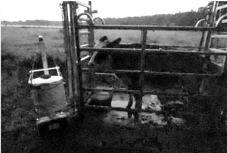
Abbildung 6: Versuchsaufbau im Vorversuch mit Sentinel ® UV-Lichtfallen während der Abenddämmerung, Groß Kreutz, Juni 2011
