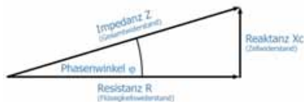
Abb. 24 Zusammenhänge der durch die BIA erfassten Widerstände und dem Phasenwinkel, nach (96;109) neu erstellt
