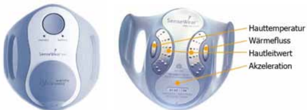
Abb. 32 Vorder- und Rückseite des SenseWear-Gerätes (Pro3) mit Darstellung der jeweiligen Sensoren und den jeweils erhobenen Messparametern, nach (87) modifiziert
