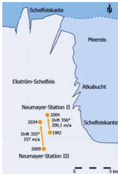
Abb. 9 Lage und Driftbewegungen der Stationen Georg-von-Neumayer II und III im Ekström-Schelfeis, nach (5) neu erstellt
