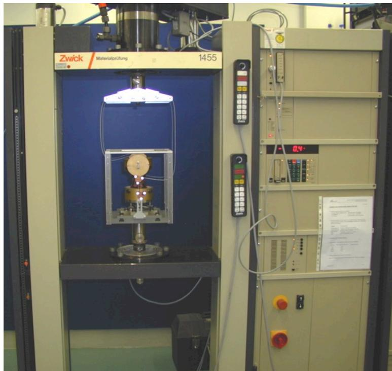
Abb. 2-14: Wirbelsäulen-Prüfstand installiert in der Zwick
