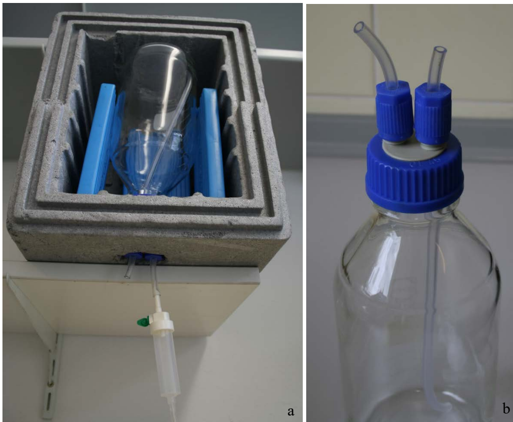
Abb. 9: a: gekühlter Blutvorrat in der Flasche (hier ohne Blut); langer Schlauch zur Belüftung der Flasche; langer Schlauch zum Anschluss des Infusionsbesteckes; b: Detailaufnahme der Glasflasche mit 2 Oliven und Silikonschläuchen
