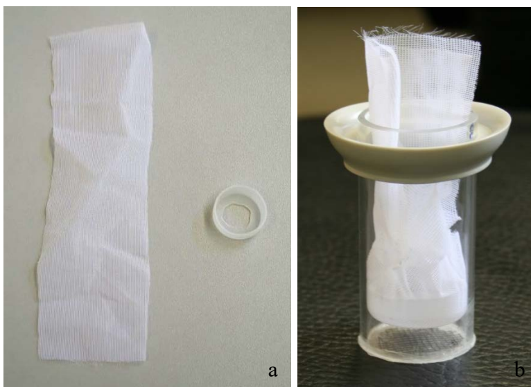
Abb. 7 a und b: Deckel, der bis 5–10 mm über die Membran geschoben wird; verwendet ab Oktober 2013
