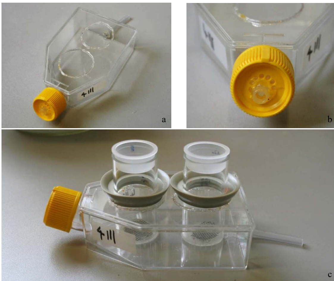
Abb. 8: Durchflusskammer aus Polystyrol; a: Schrägaufsicht; b: Detailansicht des Deckels mit eingeklebtem breiteren Ende einer 200- \mu l-Pipettenspitze; c: Durchflusskammer mit eingehängten Zeckenkammern aus Glas; zwischen den Silikonmembranen und dem Boden der Durchflusskammer befindet sich ein 1–2 mm breiter Spalt (hier ohne Futterblut)
