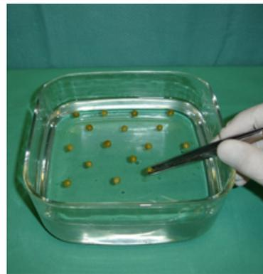
Abdeckung der Erbsen mit der zweiten Kerzengelschicht bis zur gewünschten Höhe (im Experiment 3cm)
