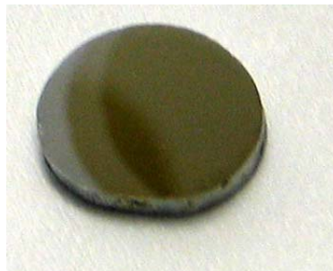
Abbildung 7.2-1: Runder Re-Kristall mit sichtbarer TiO_2 -Schicht (mehrere Aufdampfpositionen), die dunkelbraune Stelle in der Mitte entspricht einer Aufdampfzeit von 90 Minuten bei einem Titanfluss von 1,5 Titanmonolagen pro Minute
