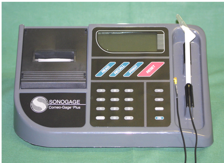
Abbildung 7: Ultraschallgerät Corneo-Gage™Plus 2 von Sonogage mit 50 MHz (US50)
