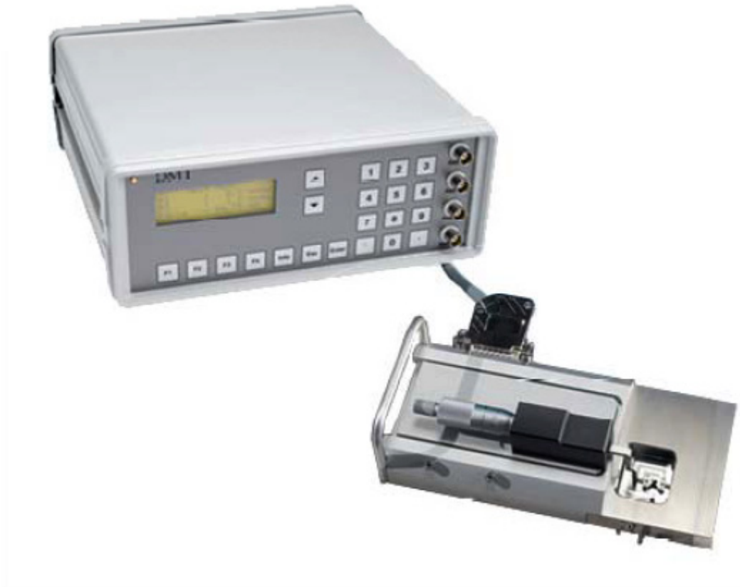
Abbildung 7: Ein Kleingefäßmyograph (Modell 310A) der Firma Danish Myotechnology (Quelle: http://www.dmt.dk )
