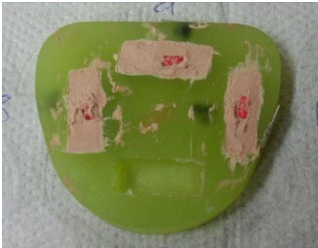
Abb. 3: fixierte Prüfkörper in Löt-Einbettmasse
