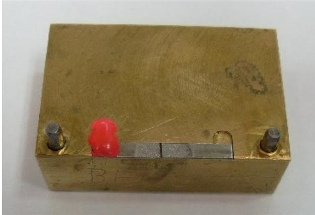
Abb. 2: Fixierung der Gerüsthälften mit definiertem Abstand
