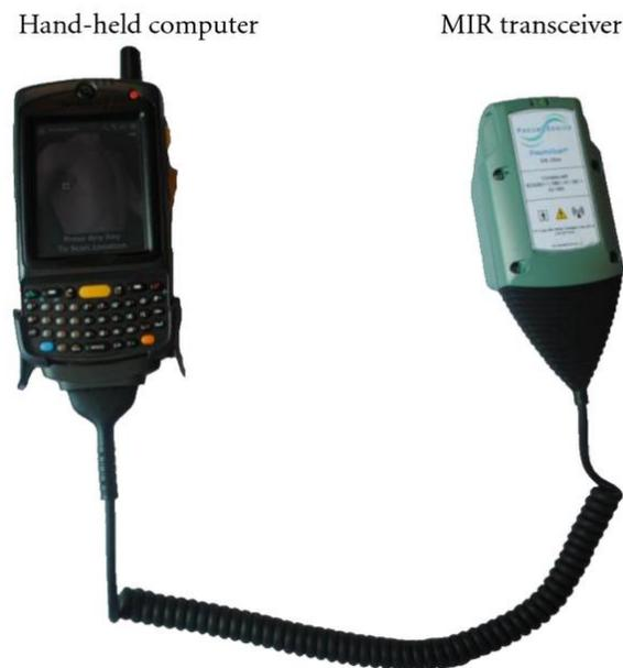
**Abbildung 6** Die zwei Komponenten des PneumoScan™-Prototypen: links der Handheld-Computer, rechts die Scan-Einheit (MIR-Transceiver)
