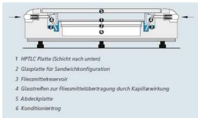
Abb. 21: Aufbau der Horizontal-Entwicklungskammer der Firma CAMAG
