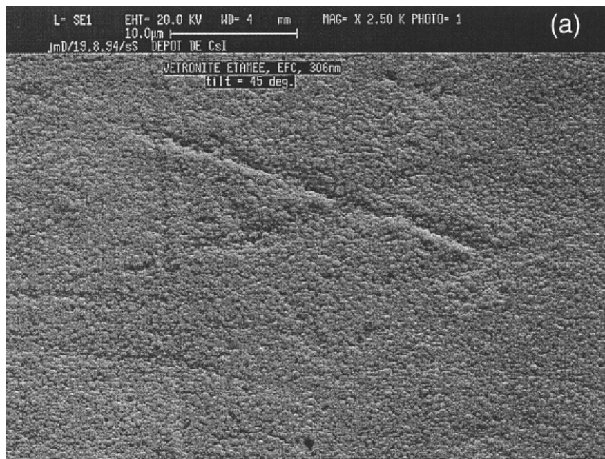
Abbildung 3.12: Eine CsI-Schicht mit einer Dicke von 500 nm auf G10/Cu/Ni/Au [Alm95b].
