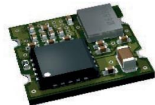
Abbildung 24 Funkmodul, PAN2355 [Pana11]
