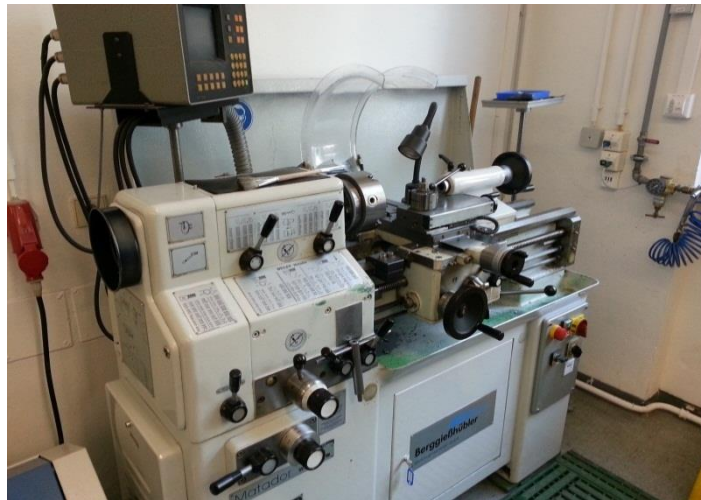
Abbildung 69 Drehbank, Modell „Matador“ der Firma Hahn & Kolb, Stuttgart
