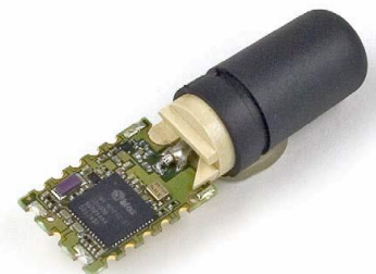
Abbildung 21 GPS-Modul, FSA03 [Falc11]
