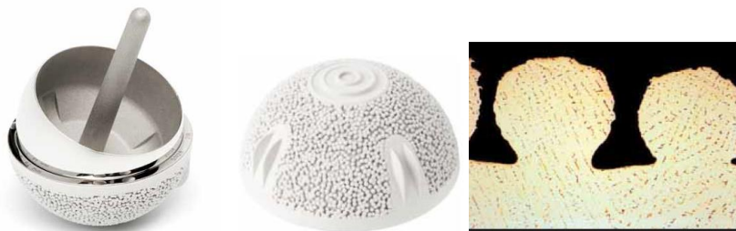
Abb. 8a: BHR-Prothese, poröse Oberfläche der Pfannenkomponente / 8b: Porocast-beads im Querschnitt, Durchmesser ca. 1mm [nach 60]
